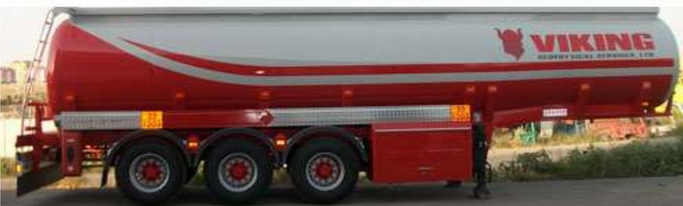
Оси большегрузных автомобилей и прицепов к ним могут состоять из двух или даже трех осей, максимально сближенных друг с другом. Эту конструкцию в технике принято называть «тележкой».
